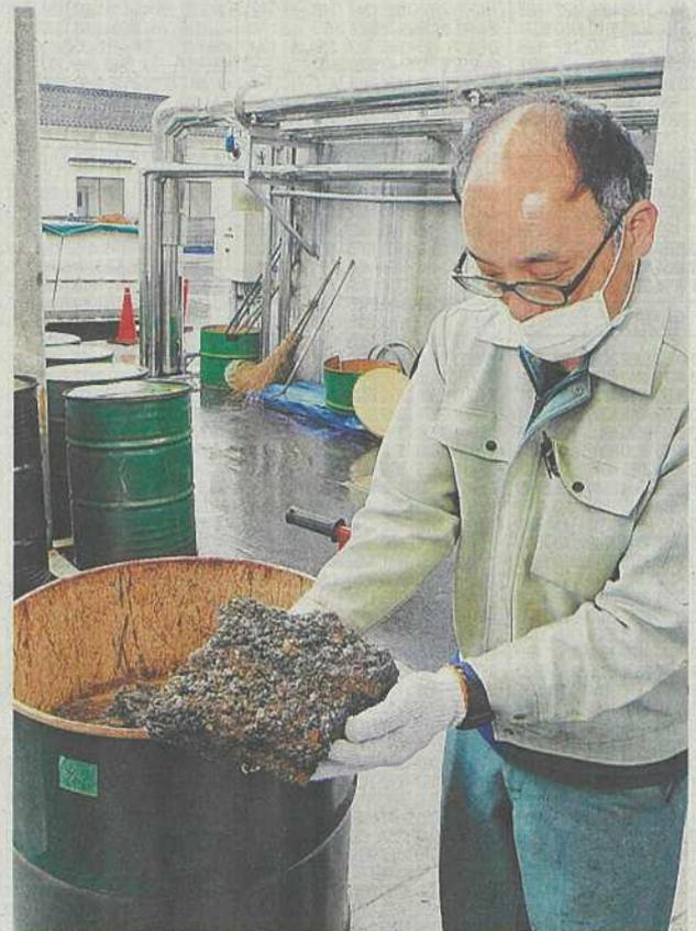
多い日は炉内にドラム缶3分の2ほど固着する燃焼かす「クリンカー」=鳥取市晩稻の社会福祉法人ウイズユ千代クリーニング工場
